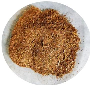
Em sequência as folhas trituradas passaram pelo processo de liofilização em período de 78 h, com a temperatura de 58 °C e pressão de 984 µmHg, após este processo obtém o extrato liofilizado conforme figura 3.
